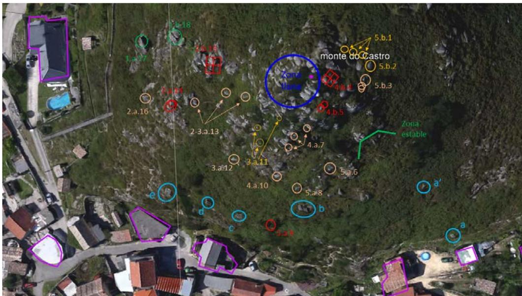
**Figura 14.** Foto aérea donde se indican todas las zonas de inestabilidad posibles observadas. Con código numérico, los cuadrados se refieren a zonas de macizo rocoso in-situ y los círculos se refieren a bloques que no están en su posición original, ya están ya desprendidos. Con letra, en los círculos azules se marcan los bloques caídos en el pasado y en morado se marcan la posición de los edificios que se pretende proteger del impacto de rocas.
